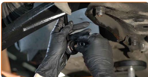
**14** Aperte o fixador que conecta a bieleta da barra estabilizadora à barra estabilizadora. Use uma chave soquete nº 17. Use uma chave de torque. Aperte-o para o torque de 36 Nm.
