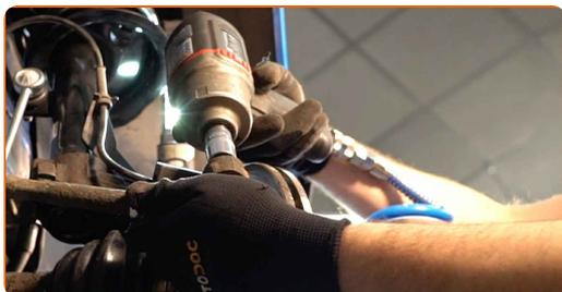
**10** Desconecte o terminal de direção da manga de eixo. Use um saca-pino. Use um martelo.
