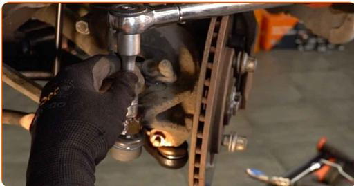
**18** Apertar a porca de bloqueio do terminal de direção. Use uma chave combinada nº 19 (2 peças). Use uma chave de torque. Aperte-o para o torque de 62 Nm.
