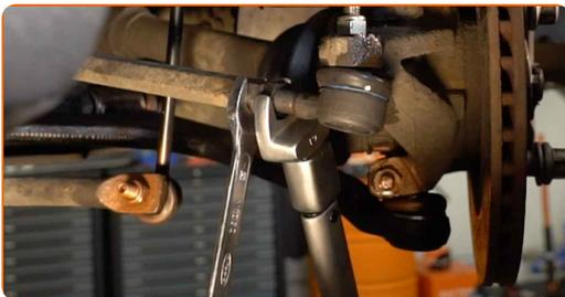
**19** Trate a porca de fixação conectada ao terminal de direção à manga de eixo. Use massa de cobre.
