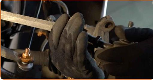
12 Limpe os assentos de montagem do terminal da direção. Use uma escova metálica. Use spray WD-40.
