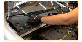
Ligue os retentores da parte superior do encaixe do microfiltro.
