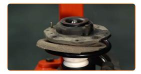
Aperte a porca do suporte do amortecedor da haste do pistão. Use uma chave soquete nº 22. Use HEX n.º H7 Use uma chave de torque. Aperte-o para o torque de 49 Nm.
