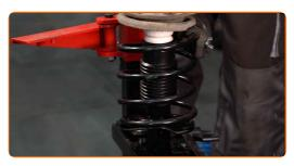
Retire a coluna de suspensão montada.
