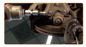
Remova o parafuso de fixação. Use um saca-pino. Use um martelo.
