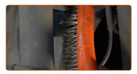
Desaparafuse o fixador que conecta a bieleta da barra estabilizadora à coluna do amortecedor. Use uma chave soquete nº 17.
