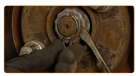
Limpe os fixadores do eixo motor. Use uma escova metálica. Use spray WD-40.
