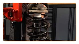
Instale o amortecedor no arco da roda.
