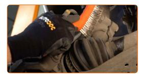
Desaparafuse o elemento de fixação inferior que liga a coluna de suspensão às mangas de eixo. Use uma chave soquete nº 16. Use uma chave de tarraxa.
