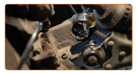
Desapertar a fixação superior de montagem do suporte do amortecedor. Use uma chave soquete nº 14.
