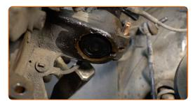
Aparafuse o fixador que conecta o amortecedor à manga de eixo. Use uma chave soquete nº 16.
