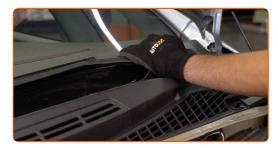
Aperte os fixadores dos braços do limpa vidros. Use uma chave soquete nº 16. Use uma chave de torque. Aperteo para o torque de 19 Nm.
