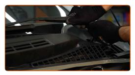
6 Separe o retentor da parte superior do encaixe do microfiltro.
