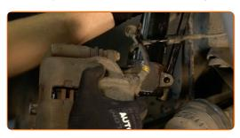
Instale o parafuso de fixação. Use um martelo.
