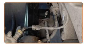
Desaparafuse o fixador que conecta bieleta da barra estabilizadora à barra estabilizadora. Use uma chave soquete nº 17. Use uma chave de torque. Aperte-o para o torque de 40 Nm.
