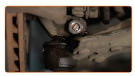
Aperte o fixador da articulação esférica. Use uma chave soquete nº 17. Use uma chave combinada nº 17. Use uma chave de torque. Aperte-o para o torque de 44 Nm.
