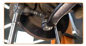
Instale o terminal do estabilizador transversal.
