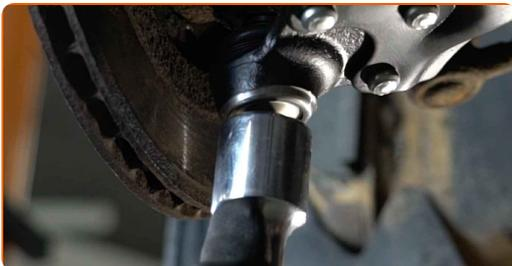
Substituição: braço inferior da parte dianteira – CITROËN ZX Hatchback (N2).
