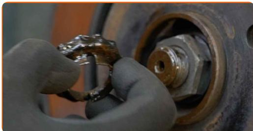
9 Desaperte o fixador que liga o eixo de transmissão ao cubo de roda. Use uma chave soquete nº 36. Use uma chave de tarraxa.
