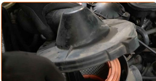
**8** Remova o elemento de filtro a partir da caixa do filtro.
