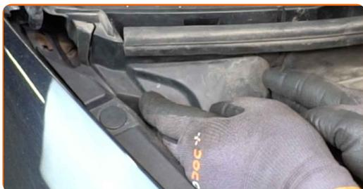
**4** Remova a tampa do suporte do dispositivo amortecedor.
