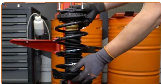
**43** Retire a coluna de suspensão montada.
