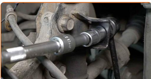
**19** Remova a bieleta da barra estabilizadora.
