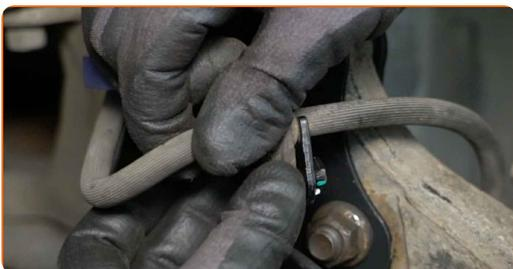
**54** Instale o parafuso de fixação.
