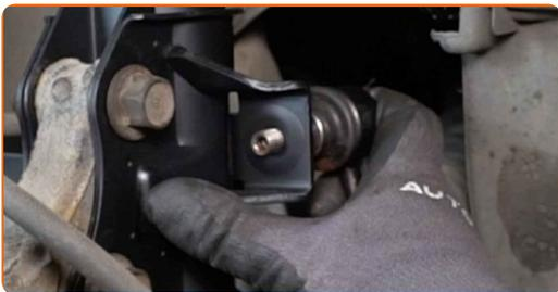
**51** Desaparafuse o fixador que conecta bieleta da barra estabilizadora à barra estabilizadora. Use uma chave soquete nº 17. Use uma chave de torque. Aperte-o para o torque de 30 Nm.
