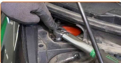
**64** Instale a tampa do suporte do dispositivo amortecedor.
