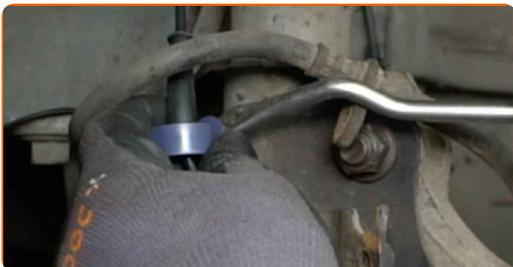
**17** Limpe o parafuso que liga a bieleta da barra estabilizadora à torre de suspensão. Use uma escova metálica. Use spray WD-40.
