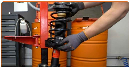
**44** Instale o dispositivo amortecedor na cava da roda.
