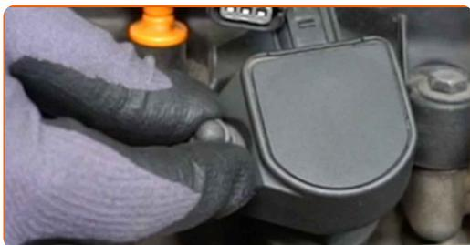
**17** Tighten the ignition coil fasteners. Use uma chave soquete nº 10. Use uma chave de torque. Aperte-o para o torque de 9 Nm.
