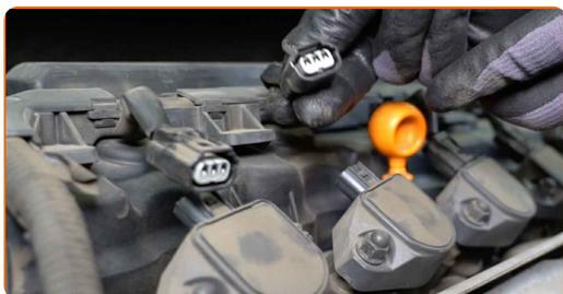
**6** Desaperte os fixadores das bobinas de ignição. Use uma chave soquete nº 10. Use uma chave de catraca.
