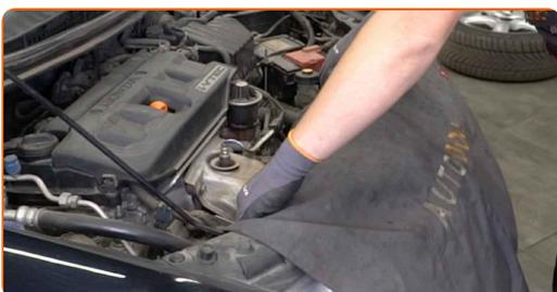
**3** Desparafuse os elementos de fixação da cobertura do motor. Use uma chave de fenda plana.
