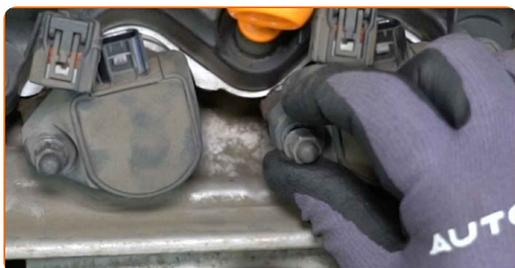
**8** Retire as bobinas de ignição dos poços das velas de ignição.
