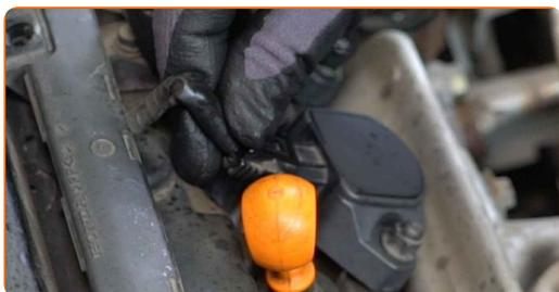
**20** Instale a cobertura do motor e fixe-a.
