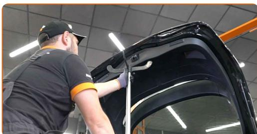
**3** Solte o anel de retenção que liga o amortecedor à tampa da bagageira. Use uma chave de fenda plana.
