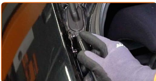
**16** Encaixe o anel de retenção que liga o amortecedor à tampa da bagageira.
