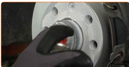
**35** Limpe a superfície do disco de travão. Utilize um produto de limpeza para travões.
