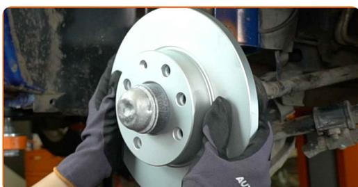
**21** Aparafuse o fixador do disco de travão. Use a chave Phillips.
