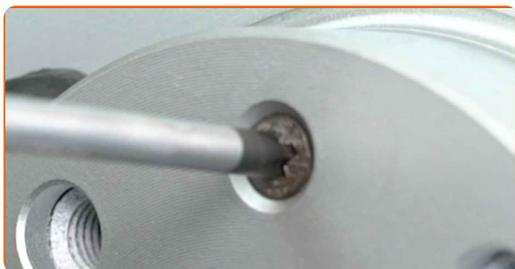
**22** Aperte a fixação do disco de travão. Use a chave Phillips. Use uma chave de torque. Aperte-o para o torque de 7 Nm.
