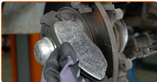
**14** Limpe os fixadores do suporte da pinça de travão. Use uma escova metálica. Use spray WD-40.
