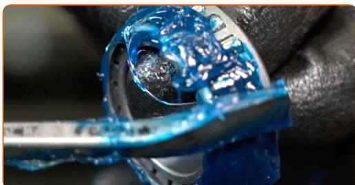
**21** Instale um novo rolamento de cubo de roda e fixe-a.
