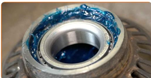
**22** Instale a junta de óleo do rolamento de roda.
