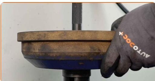
**17** Limpe o local de montagem do rolamento de cubo. Use o spray de limpeza universal.
