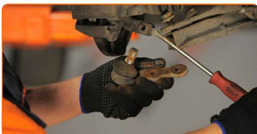
**14** Retire os parafusos de fixação (2 peças). Use uma chave de fenda plana.
