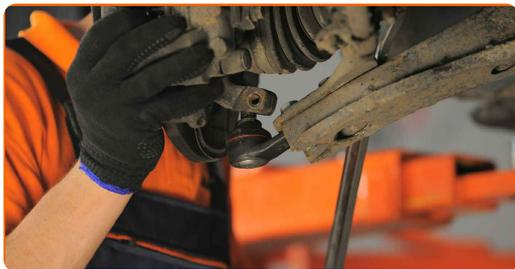
**19** Aperte o fixador da articulação esférica. Use uma chave combinada nº 18. Use uma chave soquete nº 18. Use uma chave de torque. Aperte-o para o torque de 55 Nm.
