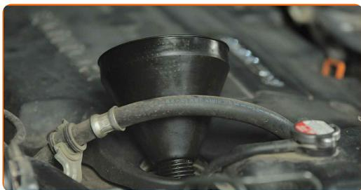
**24** Despeje o óleo no motor através do gargalo de enchimento de óleo. Quantidade necessária de óleo: 5.5 l.
