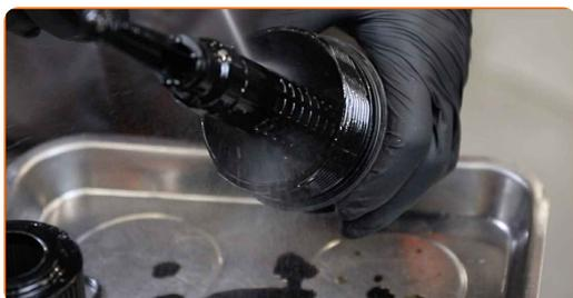
**17** Instale anéis em O novos e um filtro de óleo novo nos seus locais de montagem na tampa do filtro. Use uma chave de fenda plana.
