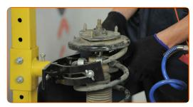
Aperte a porca do suporte do amortecedor da haste do pistão. Use uma chave combinada nº 17. Use HEX n.º H7. Use uma chave de torque. Aperte-o para o torque de 44 Nm.
