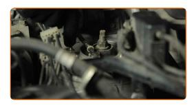
Desapertar a fixação superior de montagem do suporte do amortecedor. Use uma chave soquete nº 14. Use uma chave de catraca.
