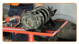
Instale o amortecedor no arco da roda.
