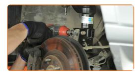
Instale o apoio no suporte do amortecedor.
