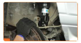
Instale os parafusos de fixação (2 peças). Use uma chave de catraca.
