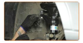
Trate os fixadores do amortecedor. Trate a porca de fixação conectada ao terminal de direção à manga de eixo. Use massa de cobre.
