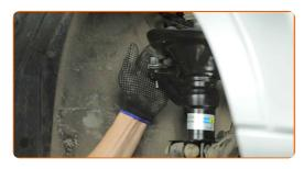
Aperte a porca de fixação conectada ao terminal de direção à manga de eixo. Use uma chave combinada nº 17. Use uma chave de torque. Aperte-o para o torque de 43 Nm.
