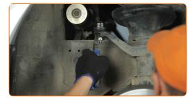
Limpe o elemento de fixação que conecta o terminal de direção à manga de eixo. Use uma escova metálica. Use spray WD-40.
