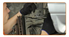
Remova o apoio do suporte do amortecedor.
