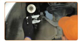
Desaperte o suporte do cabo ABS. Use uma chave soquete nº 10. Use uma chave de catraca.
