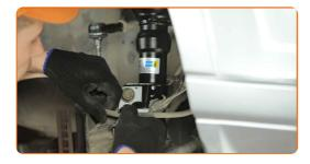
Aperte o suporte de fixação da mangueira do travão do amortecedor. Use uma chave soquete nº 12. Use uma chave de catraca.
