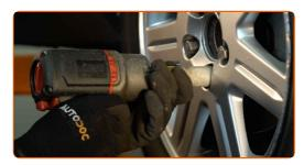
Baixar o carro e trabalhar em ordem transversal, apertar os parafusos das rodas. Use o soquete de impacto para roda #19. Use uma chave de torque. Aperte-o para o torque de 108 Nm.
