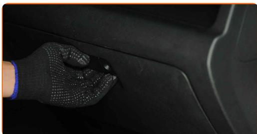
**3** Retire o cabo de travamento (cinta do cabo) da tampa do porta-luvas. Use uma chave de fenda plana.
