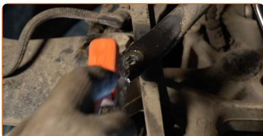
**7** Instale o terminal do estabilizador transversal.
