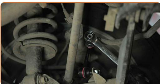
**9** Instale a fixação da haste à barra estabilizadora e aperte-a. Use uma chave combinada nº 17. Use uma chave soquete nº 17. Use HEX n.º H6. Use uma chave de torque. Aperte-o para o torque de 38 Nm.
