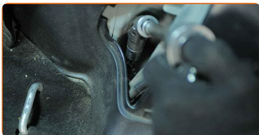
**35** Trate os fixadores do apoio da coluna de suspensão. Use massa de cobre.
