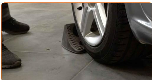
**2** Solte os parafusos de montagem das rodas. Use o soquete de impacto para roda #19.
