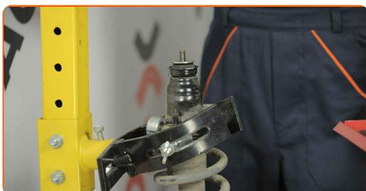
**21** Remova a montagem do suporte superior. Retire a mola.
