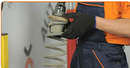
**22** Retire o amortecedor antigo do compressor hidráulico de mola.
