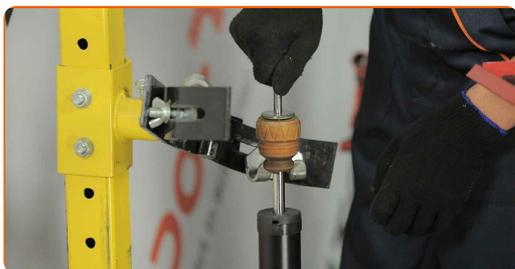
**26** Instale a mola do amortecedor. Instale o suporte superior e o rolamento do suporte.
