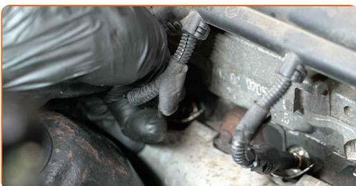
**9** Desaparafuse as velas de incandescência. Use o soquete da vela de ignição #8. Use uma chave de catraca.
