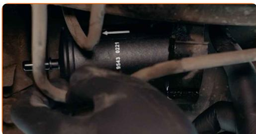
**Substituição: filtro de combustível – DACIA Dokker Carrinha (KE\_). Conselho da AUTODOC:**
