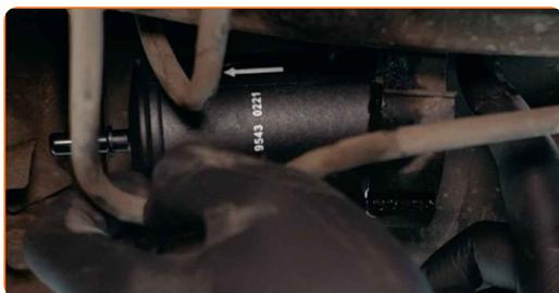
**Substituição: filtro de combustível – DACIA DUSTER Caixa. Conselho da AUTODOC:**
