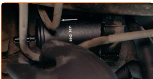
**Substituição: filtro de combustível – DACIA DUSTER. Conselho da AUTODOC:**
