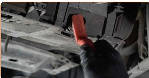
**7** Desaperte o bujão de drenagem. Use Torx T45. Use uma chave de catraca.
