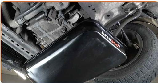
**6** Limpe a área do orifício de drenagem do cárter. Use uma escova metálica. Use o spray de limpeza universal.
