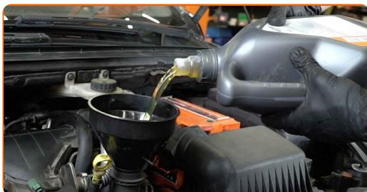
Substituição: óleo do motor e filtro – DS DS 4 II. Conselho:
