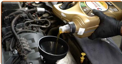
**Substituição: óleo do motor e filtro – DS DS7 Crossback. Conselho da AUTODOC:**
