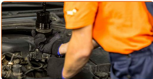
**19** Remova o elemento de filtro a partir da caixa do filtro.
