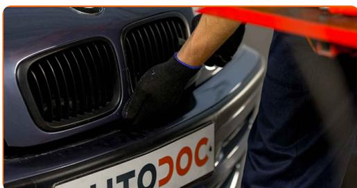
**15** Use uma cobertura de proteção para prevenir a danificação da pintura e das peças plásticas do automóvel.
