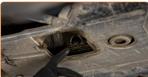
**6** Desaperte o bujão de drenagem. Use uma chave soquete nº 17. Use uma chave de catraca.
