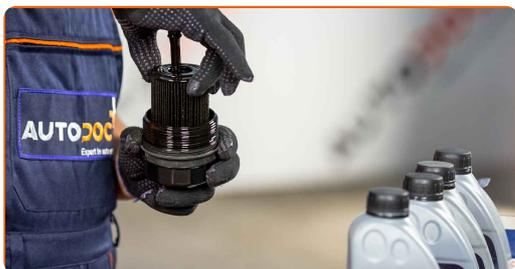
**20** Retire anéis em O antigos da tampa do filtro de óleo. Use uma chave de fenda plana.
