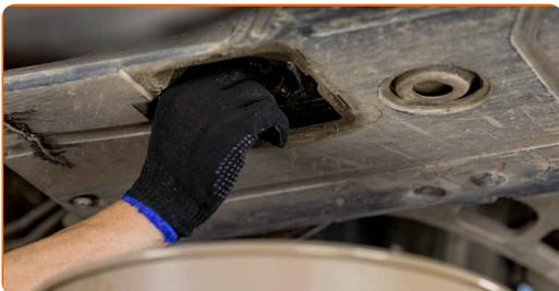
**5** Limpe a área do orifício de drenagem do cárter. Use o spray de limpeza universal.
