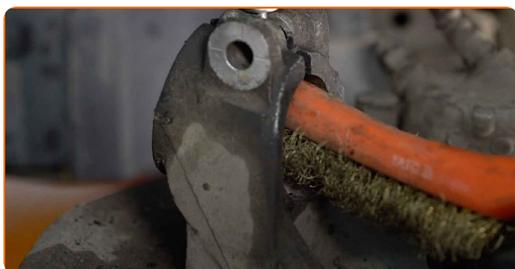
**45** Fixe o suporte do amortecedor na manga de eixo. Use um cinzel plano para metal. Use um martelo.
