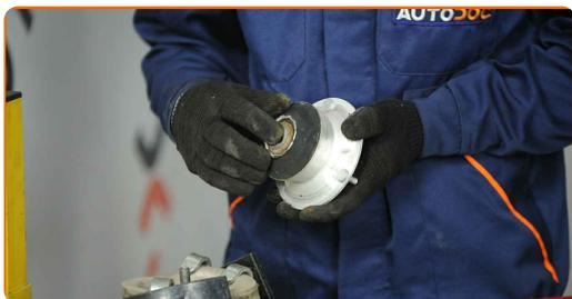
**35** Aperte a porca do suporte do amortecedor da haste do pistão. Use uma chave soquete nº 21. Use uma chave de torque. Aperte-o para o torque de 64 Nm.
