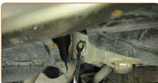
**51** Instale o terminal do estabilizador transversal.
