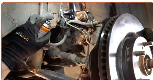
**54** Conecte a extremidade do terminal de direção à manga de eixo.
