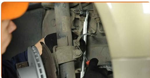
**49** Instale o fixador traseiro do braço de suspensão.
