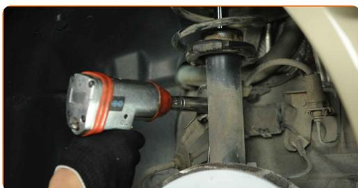
**53** Trate os fixadores do amortecedor. Use massa de cobre.
