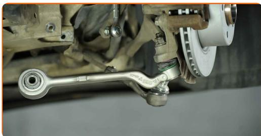
**17** Limpe os fixadores que conectam as colunas de suspensão às mangas de eixo. Use uma escova metálica. Use spray WD-40.
