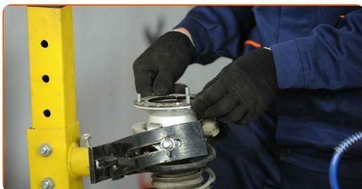
**37** Retire a coluna de suspensão montada.
