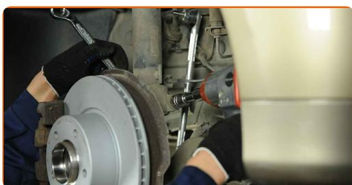
**19** Remova o parafuso de fixação.
