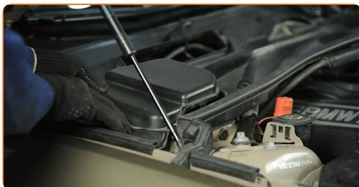
**49** Instale os fixadores da carenagem da grelha de plástico do limpa para-brisas.
