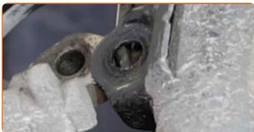
**14** Limpe os fixadores dos suportes da bucha da barra estabilizadora. Use uma escova metálica. Use spray WD-40.
