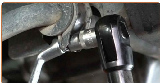
**16** Retire os parafusos de fixação.
