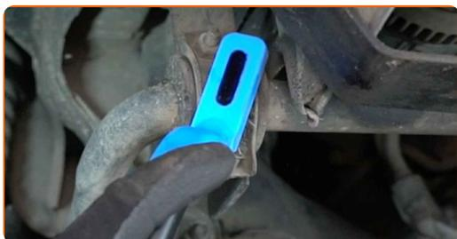
**15** Desaperte os fixadores dos suportes da bucha da barra estabilizadora. Use uma chave combinada nº 13. Use uma chave soquete nº 13. Use uma chave de catraca.
