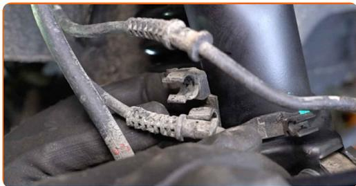
**28** Instale os suportes da bucha da barra estabilizadora. Use alicates de bomba de água.
