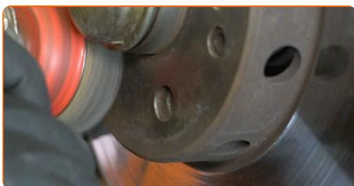
**34** Trate a superfície onde o disco de travão entra em contacto com o aro da roda. Utilize massa lubrificante de cerâmica.
