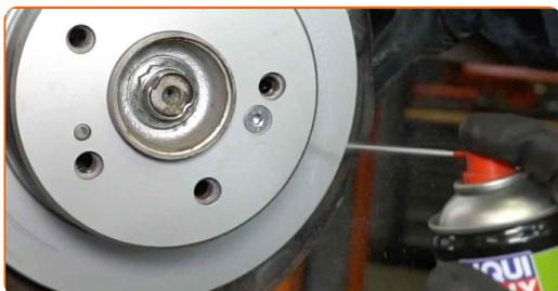
**35** Trate a superfície onde o disco de travão entra em contacto com o aro da roda. Utilize massa lubrificante de cerâmica.
