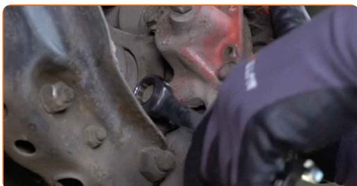
**15** Retire os parafusos de fixação.
