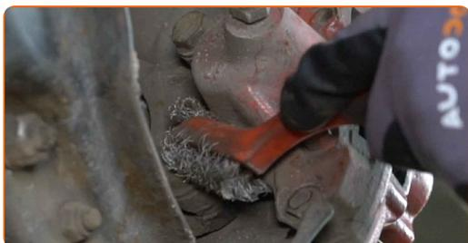
**14** Desaperte os parafusos da pinça de travão. Use uma chave combinada nº 17.
