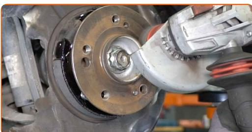
**23** Trate a superfície de contacto. Utilize massa lubrificante de cerâmica.
