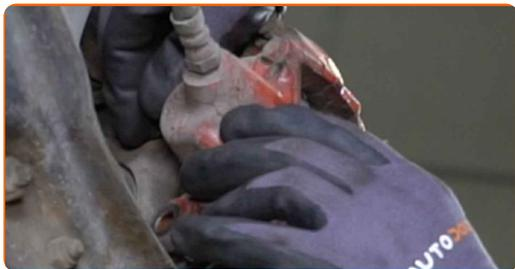
**29** Instale os parafusos de fixação.
