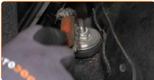
**4** Afrouxe o fixador superior do amortecedor. Use uma chave combinada nº 17. Utilize a chave para amortecedor n.º DD5.2. Use uma chave de catraca.
