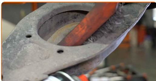
**31** Limpa os assentos de montagem dos braços de suspensão. Use uma escova metálica. Use o spray de limpeza universal.
