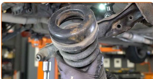
**30** Limpe os locais de montagem da mola espiral. Use uma escova metálica. Use o spray de limpeza universal.
