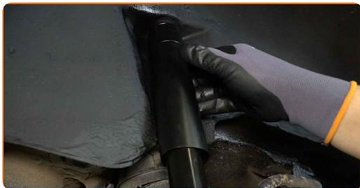
**40** Instale os elementos do suporte superior do amortecedor.
