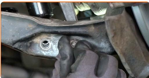
**39** Coloque o amortecedor na cava da roda e fixe-o.
