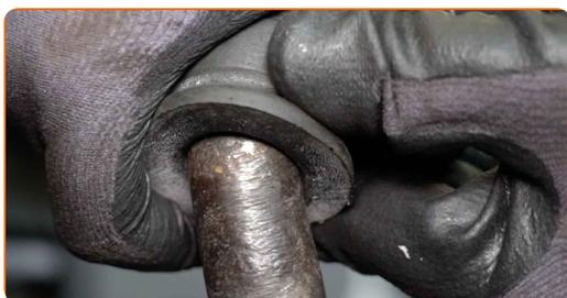
**14** Limpe os suportes dos casquilhos da barra estabilizadora. Use uma escova metálica. Use o spray de limpeza universal.
