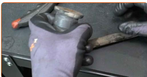
**12** Limpe os locais de montagem das buchas da barra estabilizadora. Use uma escova metálica. Use o spray de limpeza universal.
