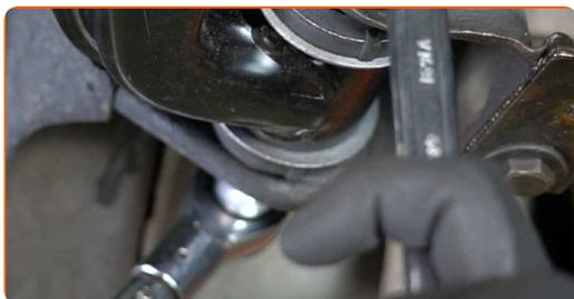
**32** Aperte o fixador dianteiro do braço. Use uma chave combinada nº 22. Use uma chave soquete nº 22. Use uma chave de torque. Aperte-o para o torque de 120 Nm.
