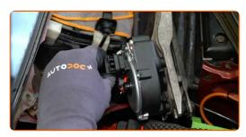
Aperte os parafusos do mecanismo do limpa-para-brisas. Use uma chave soquete nº 10. Use uma chave de torque. Aperte-o para o torque de 13 Nm.
