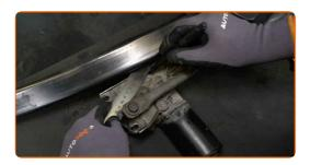
Limpe os elementos de fixação do motor do limpa-para-brisas. Use uma escova metálica. Use spray WD-40.
