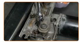
Desenrosque os elementos de fixação do motor do limpa-para-brisas. Use uma chave soquete nº 10. Use uma chave de catraca.
