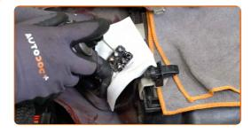
Limpe o assento de montagem do mecanismo do limpa-para-brisas. Use uma escova metálica. Use o spray de limpeza universal.
