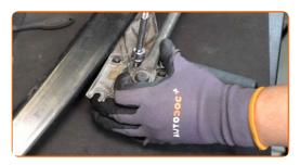
Limpe o conetor do motor do limpa-para-brisas. Use graxa dielétrica.
