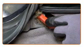
Desenrosque os parafusos do mecanismo do limpa-para-brisas. Use uma chave soquete nº 10. Use uma chave de catraca.
