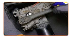
Desenrosque o elemento de fixação que liga a articulação ao veio do motor do limpa-para-brisas. Use uma chave soquete nº 13. Use uma chave de catraca.
