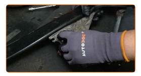
Aperte os elementos de fixação do motor do limpa-para-brisas. Use uma chave soquete nº 10. Use uma chave de torque. Aperte-o para o torque de 13 Nm.
