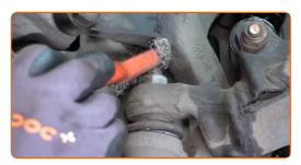
Desaparafuse o fixador que liga a junta esférica à manga do eixo. Use uma chave combinada nº 22.
