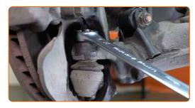
Desaperte o fixador que liga a rótula de suspensão ao braço da suspensão. Use uma chave soquete nº 22. Use uma chave de catraca.
