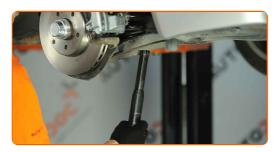
Aperte a fixação inferior do amortecedor. Use uma chave combinada nº 17. Use uma chave soquete nº 17. Use uma chave de torque. Aperte-o para o torque de 55 Nm.
