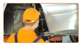
Conecte a parte inferior do amortecedor. Use uma chave de fenda plana.
