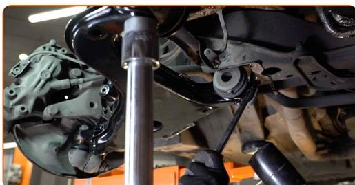
**35** Instale os fixadores do braço de controlo. Use um martelo de borracha.
