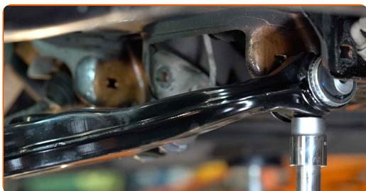
**34** Posicione o braço da suspensão de acordo com os seus furos de montagem. Use um martelo de borracha. Utilize um pé-de-cabra.
