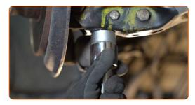
Aperte o elemento que fixa o braço de suspensão à viga do eixo traseiro. Use uma chave combinada nº 19. Use uma chave soquete nº 19. Use uma chave de torque. Aperte-o para o torque de 90 Nm.
