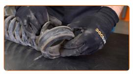
Instale o espaçador de mola de borracha à nova mola helicoidal.
