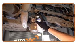
Solte o elemento que fixa o braço de suspensão à viga do eixo traseiro. Use uma chave combinada nº 19. Use uma chave soquete nº 19. Use uma chave de tarraxa.
