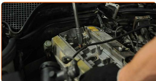
**Substituição: vela de ignição – Mercedes W210. Conselho da AUTODOC:**
