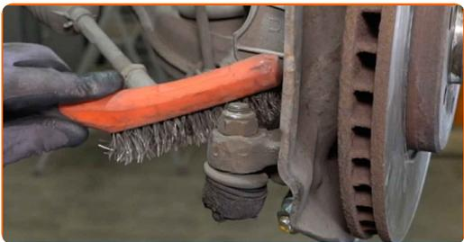
**7** Ao desinstalar, marcar ou medir a posição precisa da articulação esférica na barra de direção, ou contar o número de voltas para evitar posteriormente o desalinhamento. Use um paquímetro.
