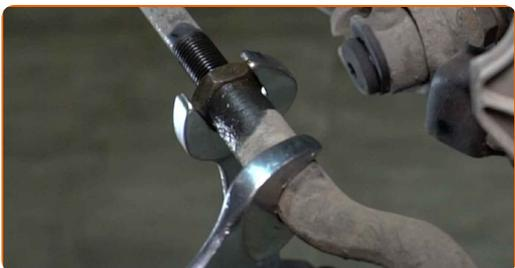
**9** Desaparafuse a porca de fixação que liga a cabeça da barra de direção à manga de eixo. Use uma chave soquete nº 22. Use uma chave de catraca.
