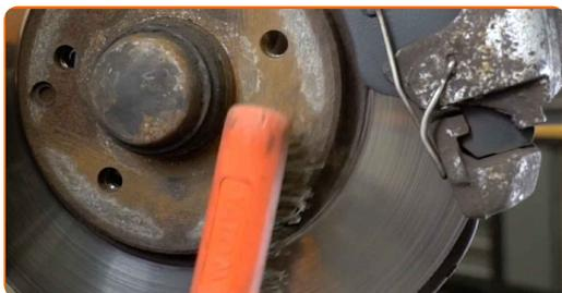
**20** Trate a superfície onde o disco de travão entra em contacto com o aro da roda. Utilize massa lubrificante de cerâmica.
