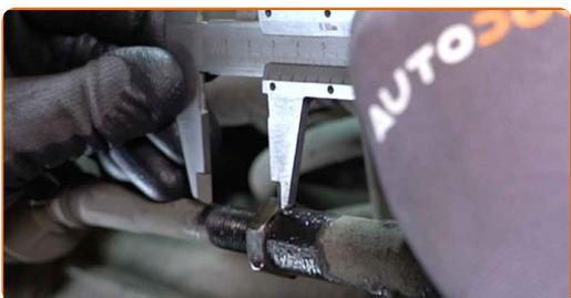
**8** Solte a contraporca que fixa a cabeça da barra de direção à barra de direção. Use uma chave combinada nº 21. Use uma chave combinada nº 22.
