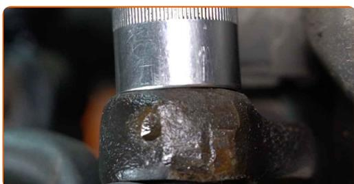
**16** Ponha o terminal da barra de direção na posição correta e fixe-o com a porca de travamento. Use um paquímetro. Use uma chave combinada nº 21. Use uma chave combinada nº 22.
