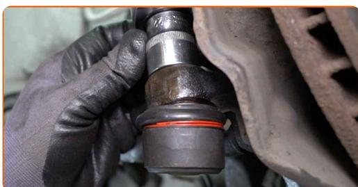
**18** Apertar a porca de bloqueio do terminal de direção. Use uma chave combinada nº 21. Use uma chave combinada nº 22. Use uma chave de torque. Aperte-o para o torque de 60 Nm.
