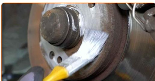
**21** Limpe a superfície do disco de travão. Utilize um produto de limpeza para travões.
