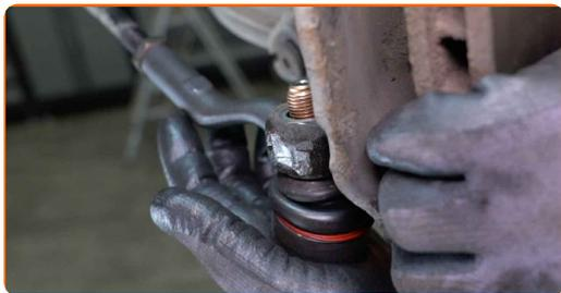
**15** Aparafuse a porca de fixação que liga o terminal de direção à manga do eixo. Use uma chave soquete nº 22. Use uma chave de catraca.
