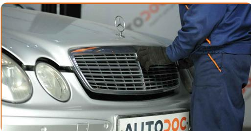
**12** Use uma cobertura de proteção para prevenir a danificação da pintura e das peças plásticas do automóvel.
