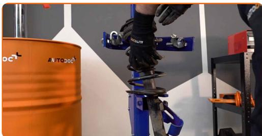
**Substituição: cabeçotes do amortecedores – Mercedes W211. Conselho da AUTODOC:**
