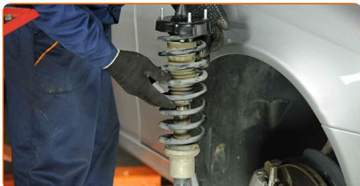
**30** Aparafuse a fixação superior de montagem do suporte do amortecedor.
