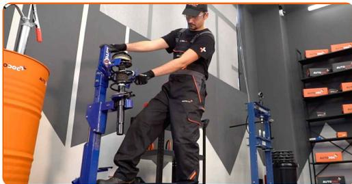
**28** Retire a coluna de suspensão montada.
