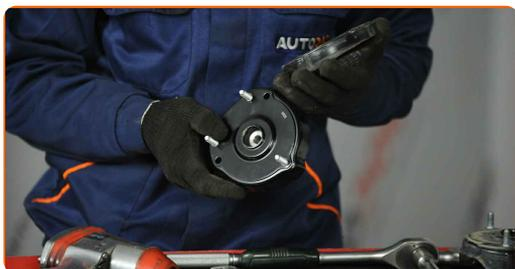
**23** Limpe o assento de montagem da coluna de suspensão. Use uma escova metálica. Use spray WD-40.
