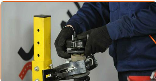
**25** Aperte a porca do suporte do amortecedor da haste do pistão. Use uma chave soquete nº 17. Use uma chave de torque. Aperte-o para o torque de 23 Nm.
