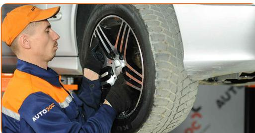
**6** Limpe o parafuso de fixação que conecta à forquilha garfo do amortecedor ao braço inferior. Use uma escova metálica. Use spray WD-40.
