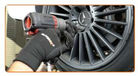
Baixar o carro e trabalhar em ordem transversal, apertar os parafusos das rodas. Use o soquete de impacto para roda #17. Use uma chave de torque. Aperte-o para o torque de 130 Nm.
