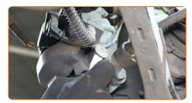
Desaparafuse a fixação de pinça de travão. Use HEX n.º H7. Use uma chave de catraca.
