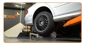
Desaperte os parafusos da roda.
