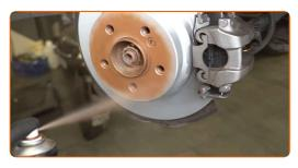
Limpe a superfície do disco de travão. Utilize um produto de limpeza para travões.
