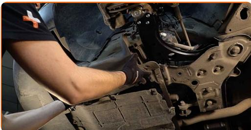
**19** Instale e aperte os elementos de fixação da cobertura do arco da roda. Use uma chave soquete nº 10. Use uma chave de catraca. Use a chave Phillips.
