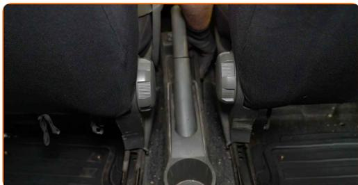
**22** Aparafuse os fixadores frontais da consola central inferior. Use uma chave soquete nº 10. Use uma chave de catraca.
