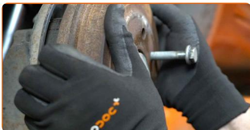
**14** Limpe o cubo. Use uma escova metálica. Trate a superfície de contacto. Use massa de cobre.
