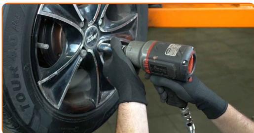
**29** Baixar o carro e trabalhar em ordem transversal, apertar os parafusos das rodas. Use o soquete de impacto para roda #17. Use uma chave de torque. Aperte-o para o torque de 98 Nm.
