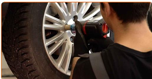
**32** Baixar o carro e trabalhar em ordem transversal, apertar os parafusos das rodas. Use uma chave de torque. Aperte-o para o torque de 120 Nm.
