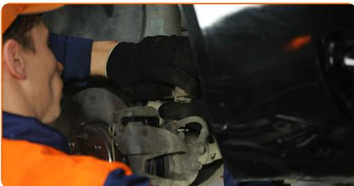
**41** Ligue o terminal de direção à manga de eixo e aperte-o. Use uma chave soquete nº 17. Use uma chave de torque. Aperte-o para o torque de 40 Nm.
