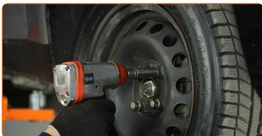
**45** Baixar o carro e trabalhar em ordem transversal, apertar os parafusos das rodas. Use uma chave de torque. Aperte-o para o torque de 98 Nm.
