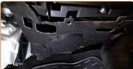
**12** Instale os cliques do painel de revestimento inferior.
