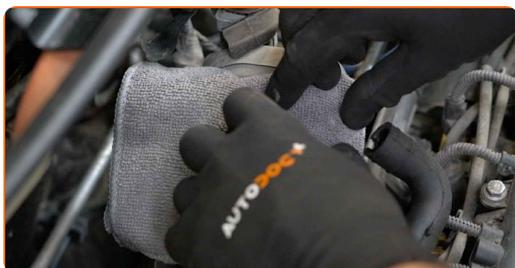
**8** Remova os conectores de fio da vela de ignição dos poços da vela de ignição. Utilize uma tenaz.
