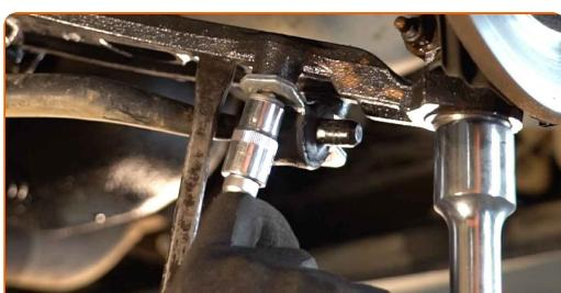
**14** Aparafuse elemento fixador que liga a barra estabilizadora ao braço de suspensão. Use uma chave soquete nº 13. Use uma chave de catraca.
