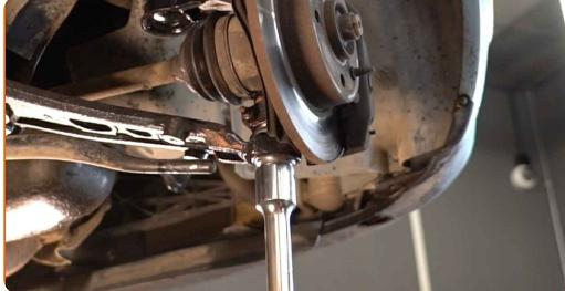
**11** Limpe os assentos de montagem do tirante da barra estabilizadora. Use uma escova metálica. Use spray WD-40.
