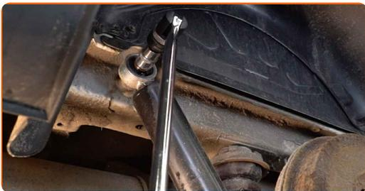
**9** Desaperte a fixação inferior do amortecedor. Use uma chave soquete nº 21. Use uma chave de tarraxa.
