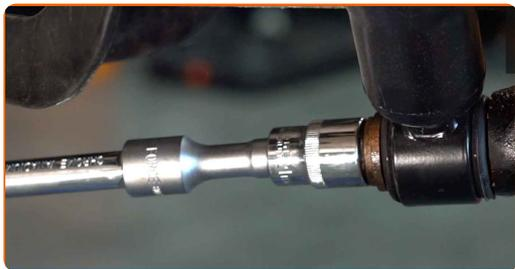
**16** Aperte o fixador superior do amortecedor. Use uma chave soquete nº 18. Use uma chave combinada nº 22.
