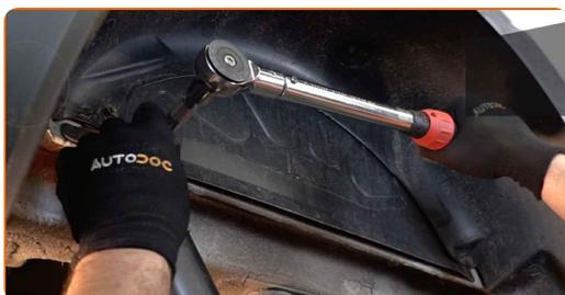
**18** Aperte a fixação inferior do amortecedor. Use uma chave soquete nº 21. Use uma chave combinada nº 21. Use uma chave de torque. Aperte-o para o torque de 110 Nm.
