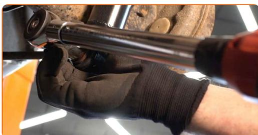
**19** Trate os fixadores do amortecedor. Use massa de cobre.
