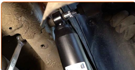
**17** Apertar a fixação superior do amortecedor. Use uma chave soquete nº 18. Use uma chave de torque. Aperte-o para o torque de 50 Nm.
