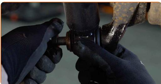
**15** Aparafuse o fixador inferior do amortecedor. Use uma chave soquete nº 21.
