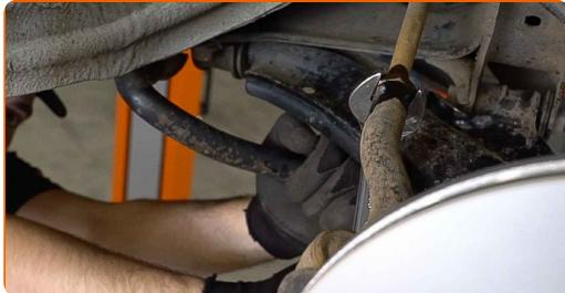
**9** Desenrosque a extremidade da porca de fixação da manga de eixo. Use uma chave soquete nº 17. Use uma chave de tarraxa.
