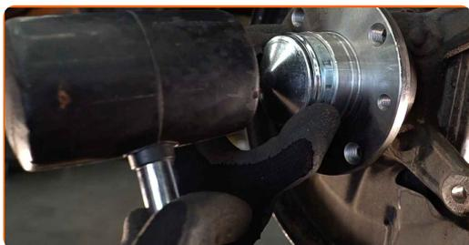
**23** Trate o cubo onde entra em contacto com o disco de travão. Use massa de cobre.
