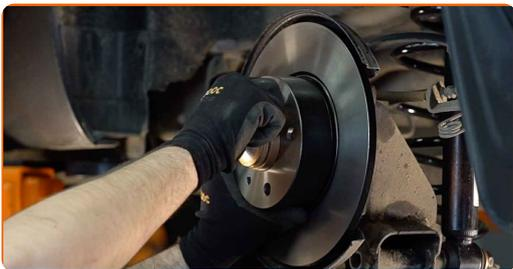
**25** Aperte a fixação do disco de travão. Use uma chave soquete nº 12. Use uma chave de torque. Aperte-o para o torque de 10 Nm.
